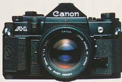
キヤノンA-1(1978年) マルチモードのTTL・AF一眼レフカメラ。フィルム感度・絞り値などの情報をすべてデジタル信号として導入し、デジタルICで制御する方式を採用している。
