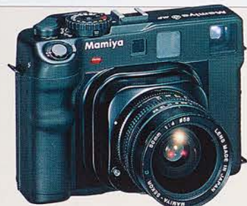
マミヤ6MF (1993年) 絞リ優先AEを可能にしたレンジファインダー式6×6判カメラ。6×6判以外に、6×4.5判や35mmフルパノラマ画面サイズでの撮影も可能なマルチフォーマットカメラ。
