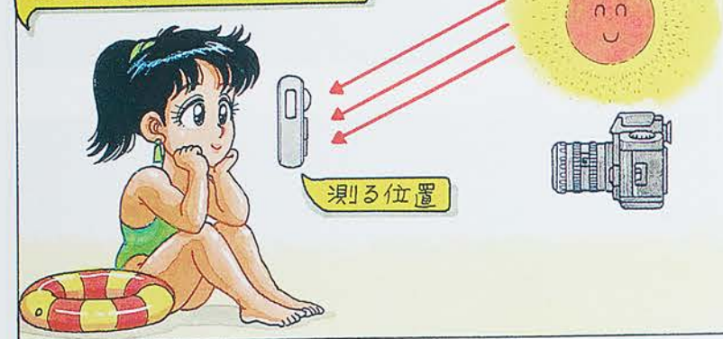
反射光式は、被写体に当たって反射した光(輝度=明るさ)を測定するのに対して、入射光式は被写体に当たる光の量(照度)を測り正確ですが、被写体位置で測らなければいけないので、機動的とはいえません。
