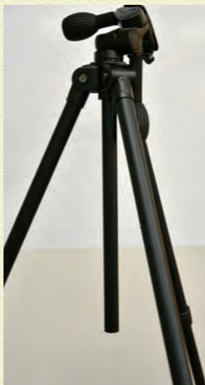
三脚のエレベーター。高さの調節ができます。ただし、高くしすぎると不安定になるので、基本的には微調整の範囲に留めましょう。高さは脚の長さや段差で調節するのが基本です。
